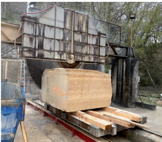
Lavage et sciage des blocs de pierre © Olivier Rambach / Société Nouvelle Saint-Pierre-Aigle
