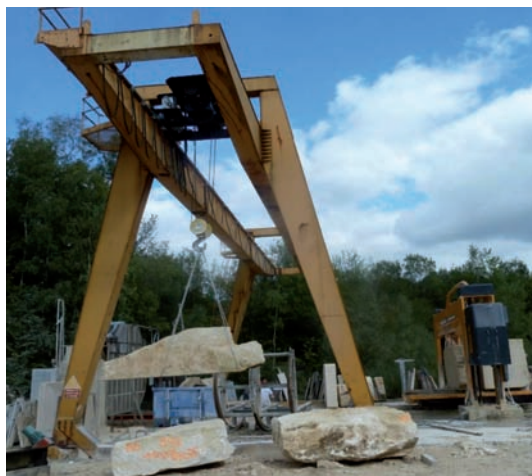
Manutention et débit primaire de blocs «bruts» dans l'usine de sciage de Saint-Pierre-Aigle (Aisne). © 2022 – D. Dessandier, BRGM
